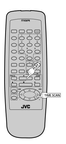
Votre magnétoscope dispose de la fonction TimeScan.
