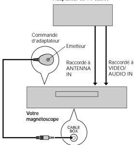
Cette procédure est nécessaire si vous recevez vos canaux TV à travers un adaptateur de TV câblée (décodeur). La commande d'adaptateur de TV câblée permet au magnétoscope de commuter automatiquement les canaux de l'adaptateur de TV câblée pendant l'enregistrement par minuterie. Elle fonctionne pour l'enregistrement de spectacles qui ont été programmés en utilisant la programmation VCR Plus+ ( p. 42) où sur écran ( pg. 44).
