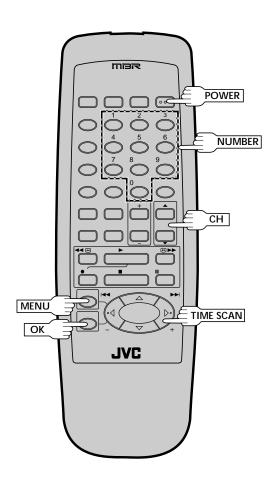
Le système de programmation de la minuterie VCR Plus+ élimine le besoin de rentrer les données pour le canal, la date, l'heure de début et de fin lors du réglage de la fonction d'enregistrement par minuterie. Tapez simplement le numéro PlusCode pour le programme que vous voulez enregistrer (indiqué dans la plupart des guides TV) et la minuterie du magnétoscope est programmée automatiquement.
